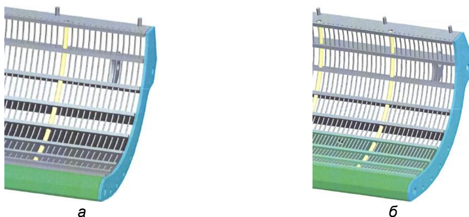
Рисунок 9 – Подбарабанье: а – старого типа; б – нового типа
