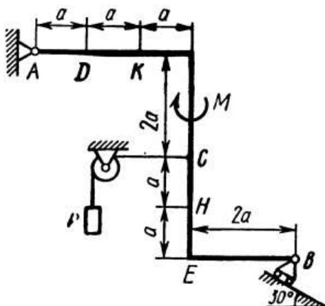
Жесткая рама, расположенная в вертикальной плоскости, закреплена в точке А шарнирно, а в точке В прикреплена или к невесомому стержню с шарнирами на концах, или к шарнирной опоре на катках. В точке С к раме привязан трос, перекинутый через блок и несущий на конце груз весом Р. На раму действуют пара сил с моментом М и силы, значение направление и точки приложения которых указаны в таблице. Определить реакции связей в точках А и В, вызываемые действующими нагрузками.
