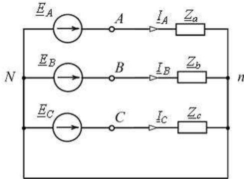
В изображенной схеме с симметричной системой ЭДС  $\underline{E}_A, \underline{E}_B, \underline{E}_C$  соотношение  $U_{л} = \sqrt{3}U_{\phi}$  выполняется \_\_\_\_\_ нагрузке (нагрузках).
